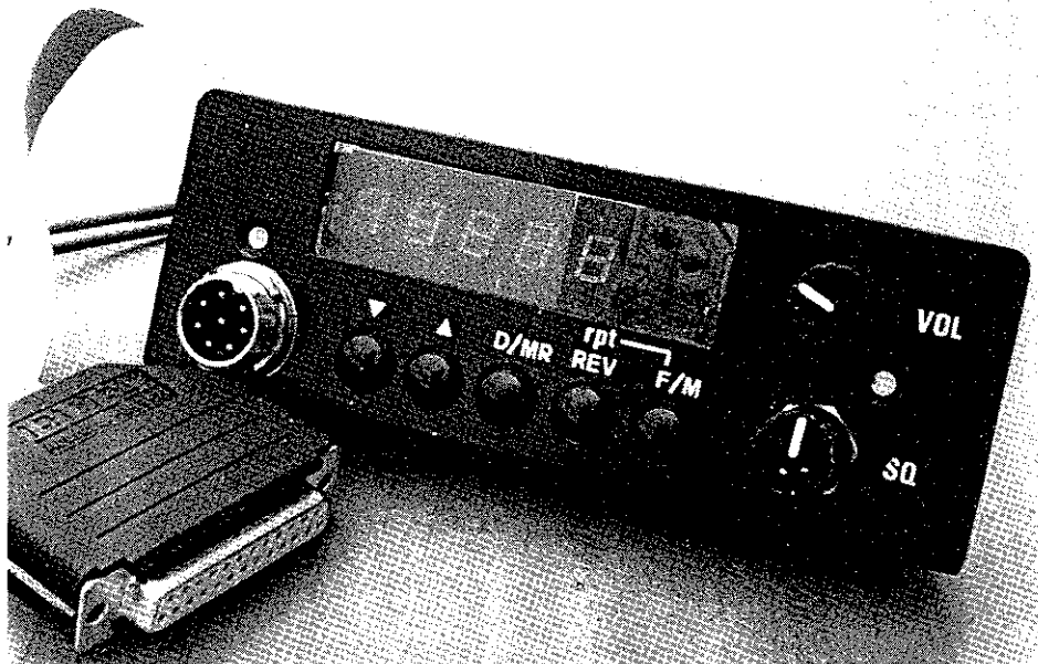
Panel i lackat kretskortslaminat som monteras istället för askkoppeln i författarens Fiat X1/9 Foto SM7NDX
